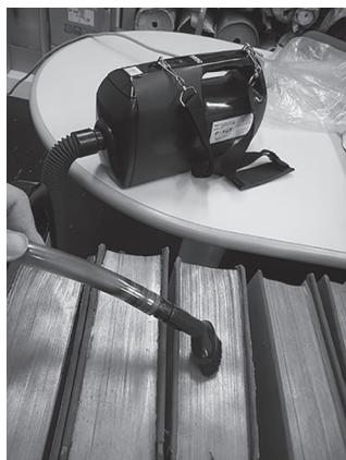
写真2：ミュージアムクリーナーで書籍の天小口の塵埃を吸引する
