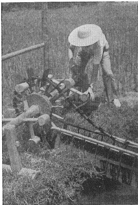
図 7、図 8 の場合、大輪は右回りに回転する。大輪、輪軸、ペダル、竜骨板、竜骨板を連結する索条の各片を繋ぐ釘，——これらは、すべて木製である。なお、索条の各片には切り込みがあり、これと大輪の歯車の歯とが噛み合っている状況が図 7 に見られる。
